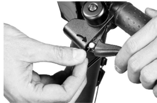
9. Нажав на рычаг тормоза, установи фиксатор троса в отверстие на ручке.
