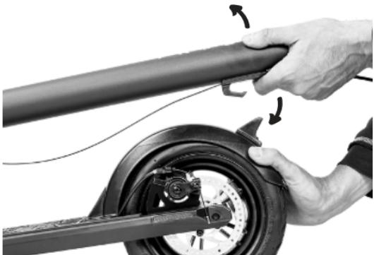
1. Нажми на заднее крыло, чтобы крючок вышел из зацепления с петлей, и подними рулевую колонку.
