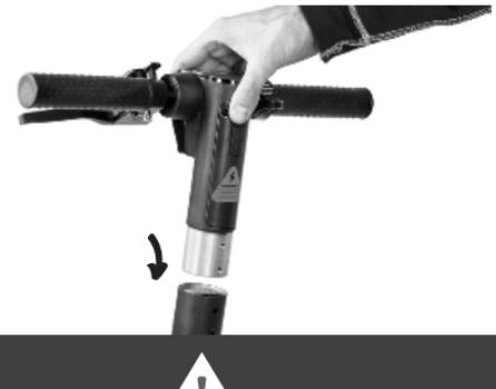
7. Аккуратно вставь руль в рулевую колонку до упора, совместив отверстия в рулевой колонке с резьбовыми отверстиями в руле.
