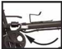
3. Откройте зажим рамы и поверните его на 90° в сторону от рамы. Приподнимите рычаг и сложите электровелосипед пополам.
