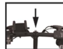
6. Выверните руль и зафиксируйте его в правильном положении с помощью зажима.
