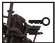
2. Разблокируйте замок ключом батареи, чтобы снять ее.
