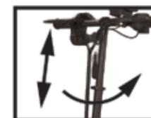
5. Отрегулируйте высоту рулевой стойки с помощью зажима.
