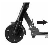
• При необходимости затяните два винта в верхней части рулевой колонки.
