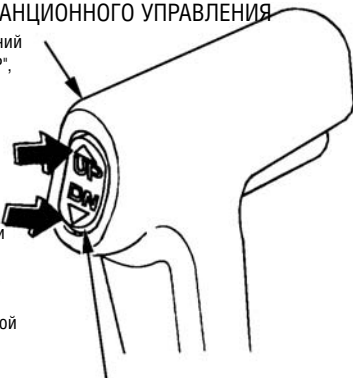
ВЫКЛЮЧАТЕЛЬ СЕРВОПРИВОДА РЕГУЛИРОВКИ НАКЛОНА/ПОДЪЕМА ИЗ ВОДЫ
