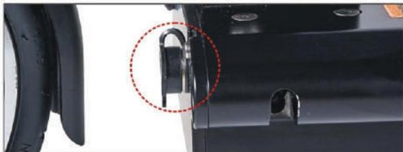
3. Откройте заглушку разъема для зарядки (см. рисунок), подключите к разъему зарядное устройство, включите зарядное устройство в сеть.
