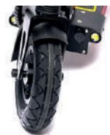
Пониженное давление может привести к неравномерному износу шин, а также создает потенциальную опасность во время резкого торможения. Эксплуатация электросамоката с изношенными или поврежденными шинами не допускается. Замену или ремонт изношенных или поврежденных шин следует выполнять своевременно.
