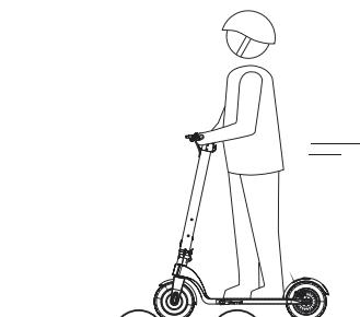
**⚠ При управлении устройством необходимо следить за наличием на пути песка, камней, поваленных деревьев, грязи, луж, льда и снега, подъемов с уклоном более 15°, ступенек, а также темных участков, и принимать соответствующие меры предосторожности.**
