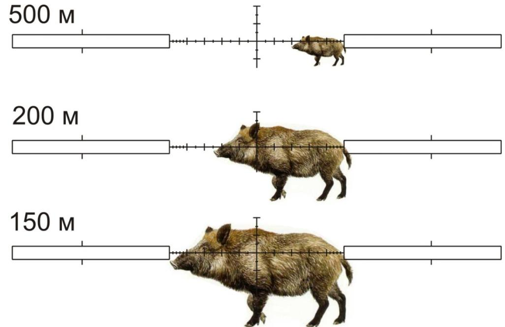
Рисунок 32 – Определение расстояния до цели по сетке «Mil-Dot»
