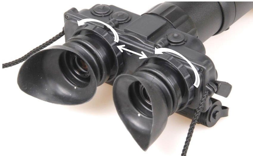
Рисунок 2 – Настройка базы глаз и диоптрийная настройка
