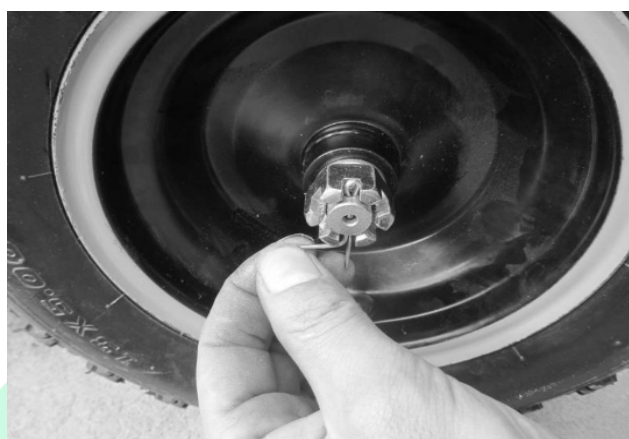
4.3. Вставьте шплинт в дырку в оси задних колес, загните концы согласно рисунку.
