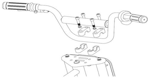
1. Освободите от упаковки и приготовьте руль к установке. Подготовьте крепежные скобы и болты руля (входят в комплектацию). Так же вам понадобиться гаечный ключ 10 мм. Зафиксируйте руль болтами при помощи 10-мм гаечного ключа.
