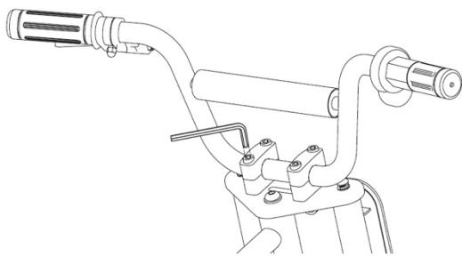
2. Поставьте руль параллельно вилке. Это лучшее положение руля для управления. Затяните болты 6мм шестигранником. Когда руль затянут правильно, он не проворачивается вперед и назад внутри крепления.
